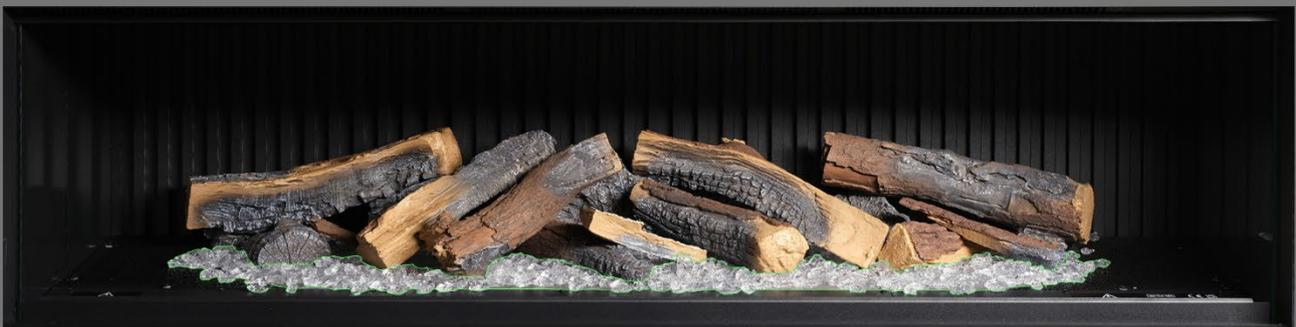
**Schritt 17:** Verteilen Sie das klare Harzgranulat an der Basis der Holzscheitimitate im hellen Bereich des Brennerbetts. Achten Sie auf eine gute Abdeckung, auch unter den erhöhten Scheiten.
