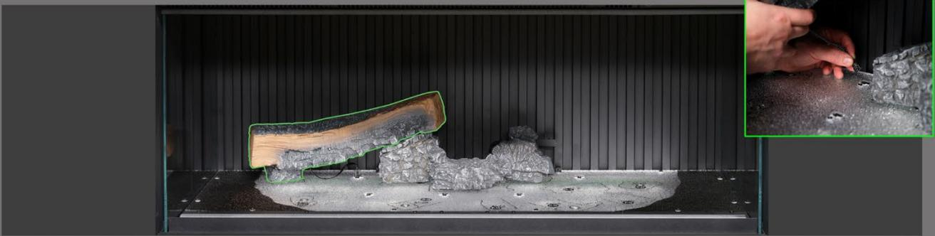
**Schritt 4:** Platzieren Sie Scheit AI-21 auf dem entsprechenden Umriss auf dem Brennerbett, stecken Sie dabei den Zapfen an der Unterseite des Scheites in das dafür vorgesehene Loch, dann stecken Sie das Kabel in die am Brennerbett befindliche Buchse.
