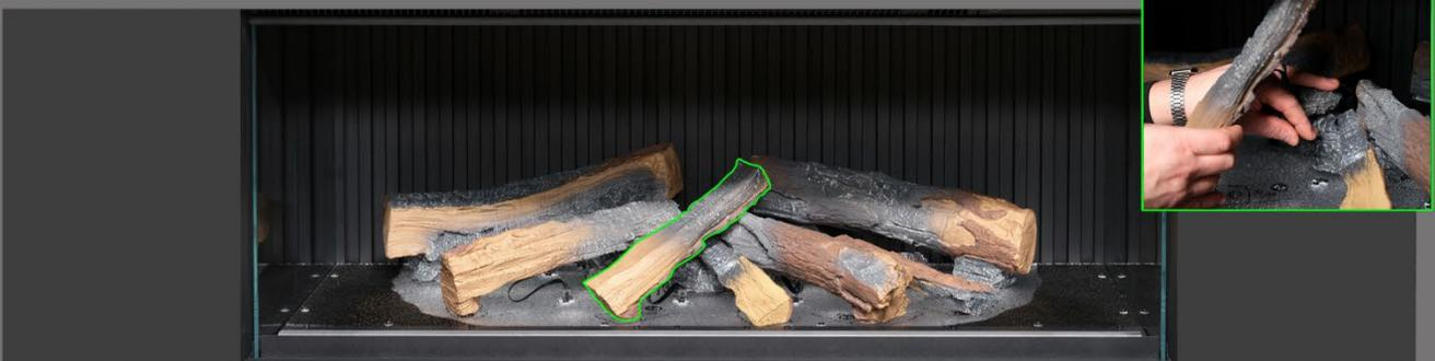
**Schritt 9:** Platzieren Sie Scheit AI-28 auf dem entsprechenden Umriss auf dem Brennerbett, stecken Sie dabei den Zapfen an der Unterseite des Scheites in das dafür vorgesehene Loch, dann stecken Sie das Kabel in die am Brennerbett befindliche Buchse.
