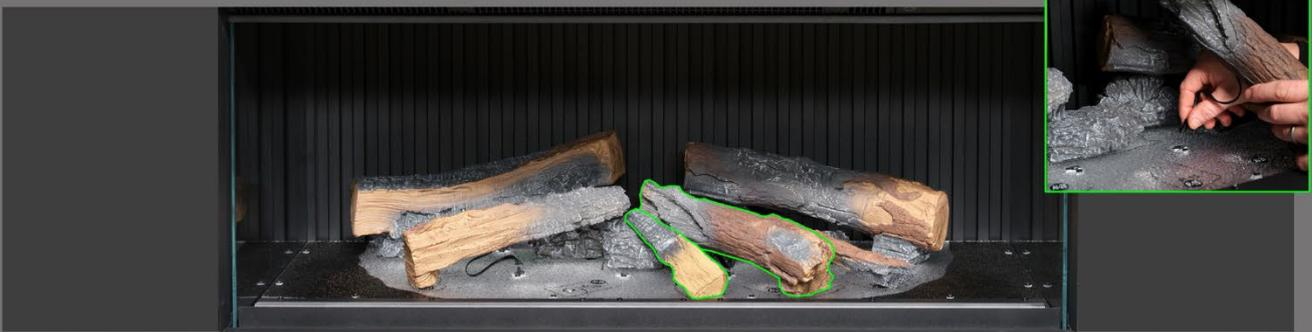
**Schritt 8:** Platzieren Sie die Scheite AI-29 und P15 auf den entsprechenden Umrissen auf dem Brennerbett, stecken Sie dabei jeweils den Zapfen an der Unterseite des Scheites in das dafür vorgesehene Loch und stecken Sie das Kabel in die am Brennerbett befindliche Buchse.
