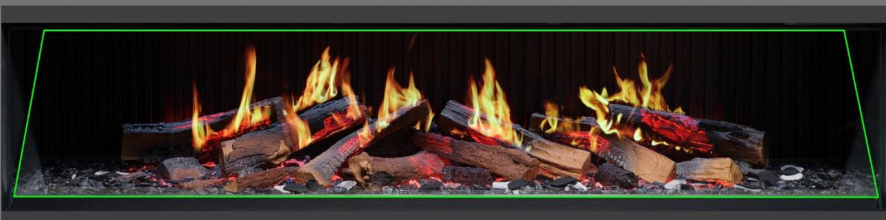
**Schritt 22:** Verteilen Sie die grauen und schwarzen Schiefer-Chips um das Brennerbett. Bringen Sie abschließend den Flammenschirm (schräge Glasscheibe) mit der richtigen Seite nach vorne wieder an. Prüfen Sie, ob die Flammen auf den Scheiten korrekt ausgerichtet sind.
