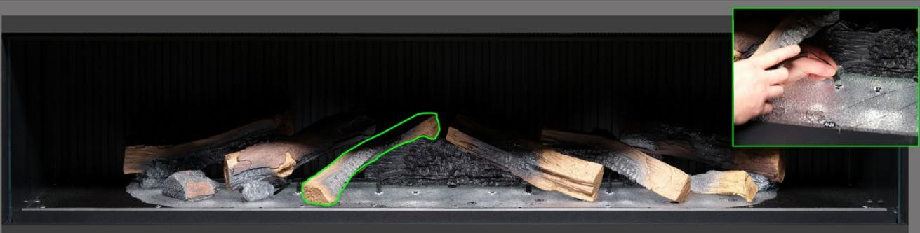
**Schritt 14:** Platzieren Sie Scheit AI-26 auf dem entsprechenden Umriss auf dem Brennerbett, stecken Sie dabei den Zapfen an der Unterseite des Scheites in das dafür vorgesehene Loch, dann stecken Sie das Kabel in die am Brennerbett befindliche Buchse.
