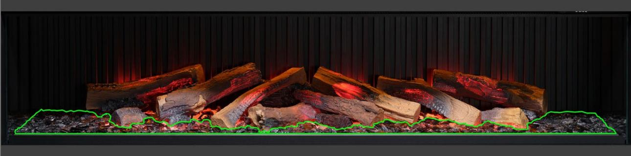
**Schritt 20:** Verteilen Sie das schwarze Glasgranulat rund um das gesamte Brennerbett, auch über dem klaren und dem schwarzen Harzgranulat. Sie müssen nicht das ganze im Lieferumfang enthaltene schwarze Glasgranulat verwenden. In dieser Phase kann es hilfreich sein, das Gerät einzuschalten, um das Brennerbett zu beleuchten und die Abdeckung mit dem Granulat zu überprüfen.
