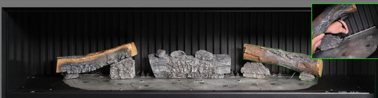
**Schritt 6:** Platzieren Sie Scheit AI-3 auf dem entsprechenden Umriss auf dem Brennerbett, stecken Sie dabei den Zapfen an der Unterseite des Scheites in das dafür vorgesehene Loch, dann stecken Sie das Kabel in die am Brennerbett befindliche Buchse.
