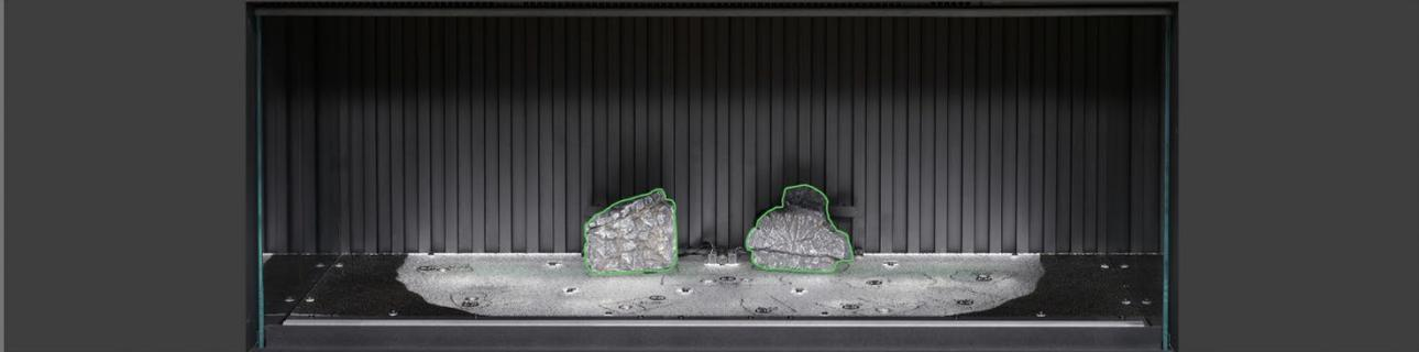
**Schritt 2:** Platzieren Sie die Scheite AI-7 und AI-8 auf den entsprechenden Umrissen auf dem Brennerbett, stecken Sie dabei jeweils den Zapfen an der Unterseite des Scheites in das dafür vorgesehene Loch.
